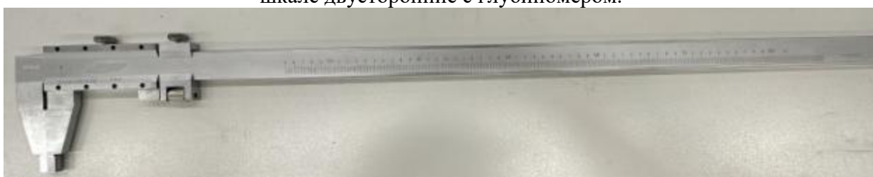
Рисунок 8 - Общий вид штангенциркуля модификации ШЦ-III- с отсчетом по нониусу одностороннего с диапазоном измерений от 250 до 800 мм
